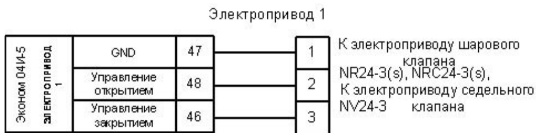
Рис. 9.6 – Схема подключения электропривода «Velimo» с трехточечным управлением к 1-му каналу
