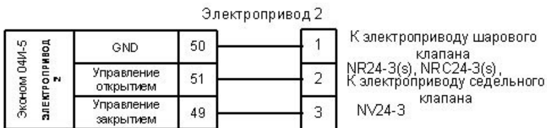
Рис. 9.7 – Схема подключения электропривода «Velimo» с трехточечным управлением к 2-му каналу
